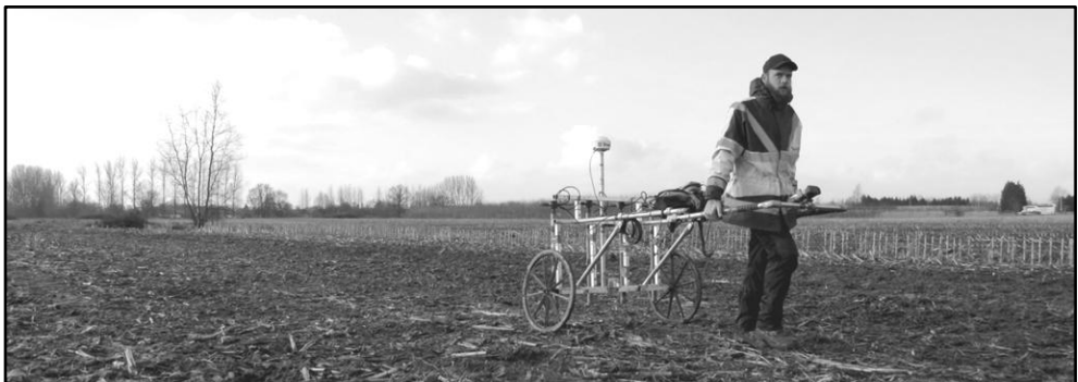
Illustratie 10. Het inmeten met magnetometers, Kalken, door detectiespecialist Michel van Orden – Bom-Be. Foto Cynrik De Decker.
