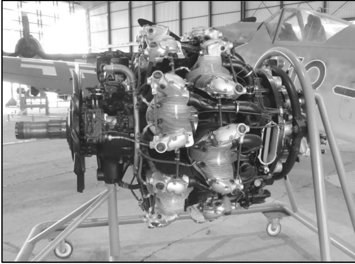
Illustratie 21. Eenzelfde BMW 801- motor in het Musée de l'Air et de l'Espace te Le Bourget (Parijs). De veertien cilinders staan in twee rijen in stervorm gemonteerd. Foto Cynrik De Decker.
